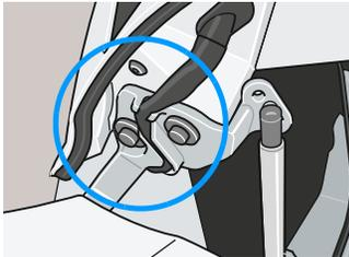
Die Flügeltüren sind mit Trennbolzen befestigt.
