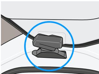
Im Crashfall (**nur bei Rollover**) werden die Trennbolzen automatisch getrennt und die Türen lassen sich entfernen.
