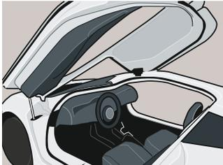
Das Fahrzeug verfügt über zwei Flügeltüren.
