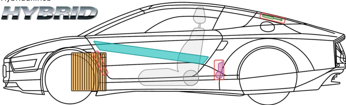
**i** Die Karosserie des Fahrzeuges besteht aus Kohlefaser-Verbundwerkstoff.
