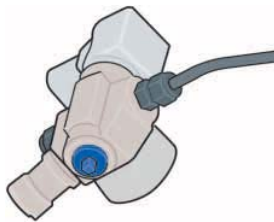
manueller Absperrhahn am Fuß des Flaschenventils.
