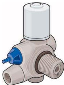
manueller Absperrhahn seitlich am Flaschenventil (bis 2008).
