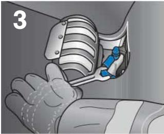
**3. Masseverbindung an der Verschraubung trennen**
