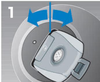
1. Bei laufendem Motor Zündschlüssel aus der Neutralstellung nach links oder rechts drehen, um Motor auszuschalten. Zündschlüssel nach Möglichkeit abziehen.
