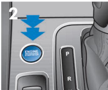
2. Start/Stop-Knopf bis zur zweiten Stufe durchdrücken
