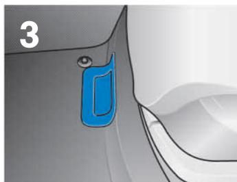
3. Zugang zur Masseverbindung der 12V-Batterie lokalisieren. Fahrersitz, falls möglich, zurückfahren.
