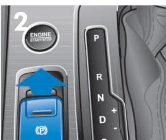
**2. Elektrische Feststellbremse betätigen**
