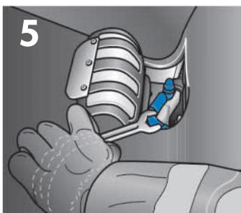
5. Masseverbindung an der Verschraubung trennen
