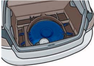
Der Flüssiggastank in der Reserveradmulde (Beispiel Golf)
