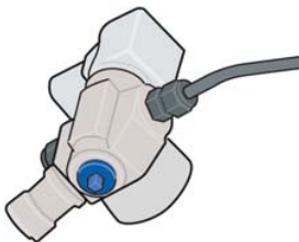
manueller Absperrhahn am Fuß des Flaschenventils.
