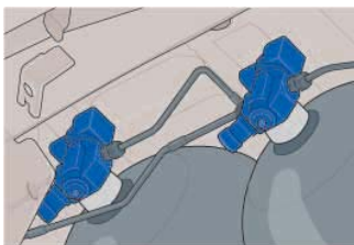
elektromagnetische Absperrentile an den Gastanks
