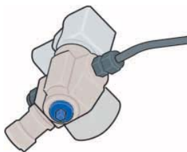
manueller Absperrhahn am Fuß des Flaschenventils.
