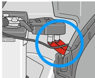
3. 12V-Batterie im Kofferraum links lokalisieren und abklemmen. Dabei beide Plusleitungen (rot) mit geeignetem Werkzeug abtrennen!
