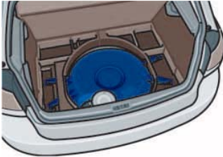
Der Flüssiggastank in der Reserveradmulde
