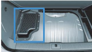
1. 12V-Bordnetzbatterie im Kofferraum lokalisieren.
