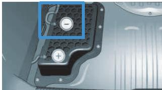
2. 12V-Bordnetzbatterie am Minuspol mit geeignetem Werkzeug abtrennen.
