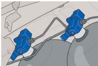
elektromagnetische Absperrventile an den Gastanks
