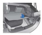
1. Kofferraumboden entriegeln und hochklappen
