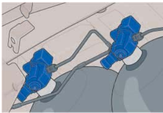
elektromagnetische Absperrventile an den Gastanks
