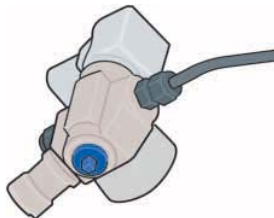
manueller Absperrhahn am Fuß des Flaschenventils.
