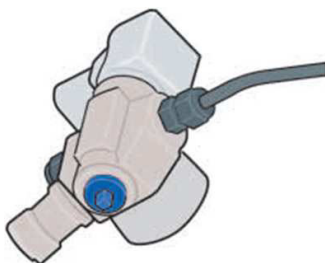
manueller Absperrhahn am Fuß des Flaschenventils.
