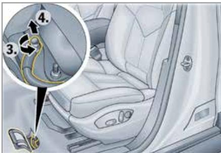
3. Das Massekabel der 12-Volt-Batterie an der Schraubverbindung trennen (-3-).
