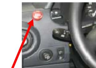
1 Not-Aus-Taster links neben dem Lenkrad betätigen
