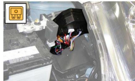
2. Dargestellte Sicherungen im Kastendeckel entfernen.
