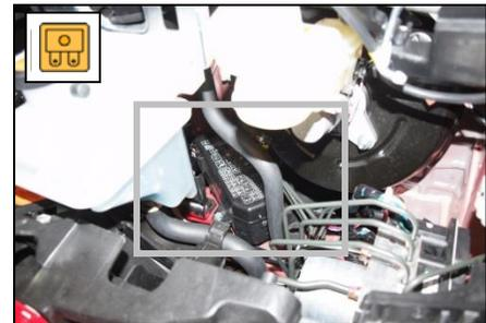
2. „Power Control Unit“-Sicherung entfernen (Nr. 7, 15 A)
