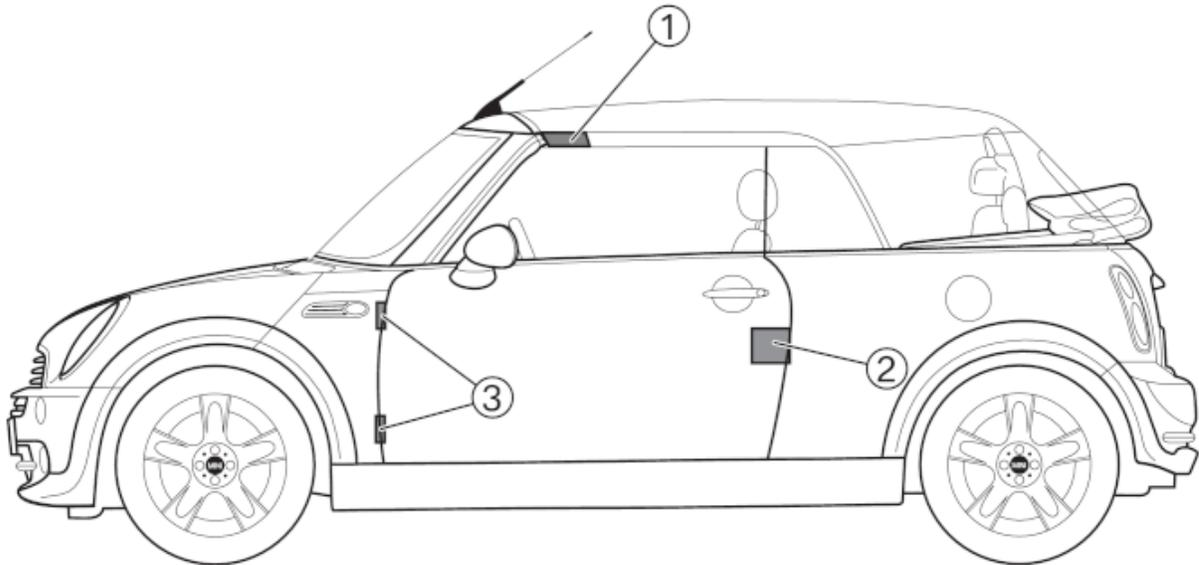
1. Die Flächen kennzeichnen die Bereiche, an denen das Dach abgetrennt werden kann. Voraussetzungen zum Aufschneiden der Karosserie sind moderne Hochleistungsscheren. Ältere hydraulische Schneidgeräte können überfordert sein.
