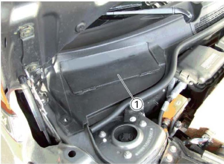
Frontklappe öffnen und Abdeckung (1) abnehmen.
