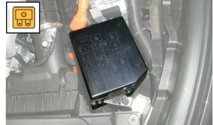
2. Dargestellte Sicherungen im Kastendeckel entfernen.
