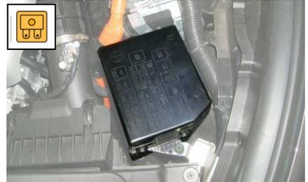
2. Dargestellte Sicherungen im Kastendeckel entfernen.
