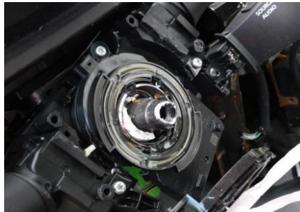
Lenksäule, hohl, teilbar hinter dem Lenkrad
