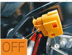
Das Hochvolt-System ist deaktiviert, wenn die Bohrung (1) durchgängig frei ist und die Beschriftung "OFF" am Stecker sichtbar ist.
