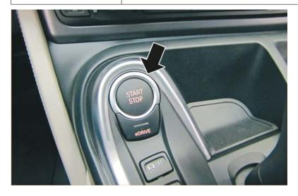
Bei laufendem Motor oder aktiven Anzeigen im Kombiinstrument Taste "START STOP" drücken, um Zündung auszuschalten.
