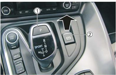
Taste (1) "P" drücken und Schalter (2) für elektrische Parkbremse nach oben ziehen.
