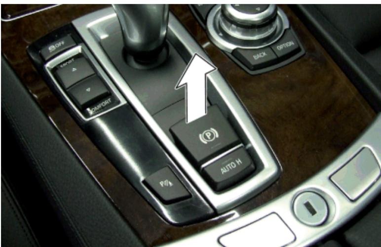
Schalter für elektrische Parkbremse nach oben ziehen.
