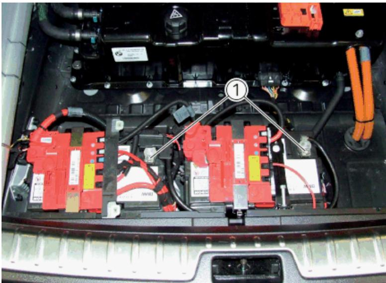
Muttern (1) lockern und Batterieminusleitungen nach oben abziehen.
