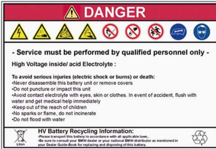
Kennzeichnung der restlichen Hochvolt-Bauteile:
