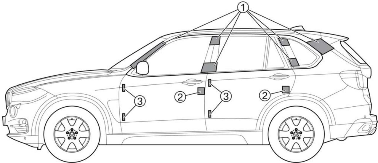
1. Die Flächen kennzeichnen die Bereiche, an denen das Dach abgetrennt werden kann. Voraussetzungen zum Aufschneiden der Karosserie sind moderne Hochleistungsscheren. Ältere hydraulische Schneidgeräte können überfordert sein.
