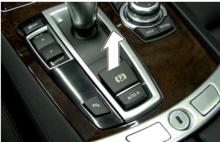
Schalter für elektrische Parkbremse nach oben ziehen.
