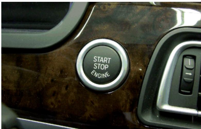
Bei laufendem Motor oder aktiven Anzeigen im Kombiinstrument Taste "START STOP ENGINE" drücken, um Zündung auszuschalten.
