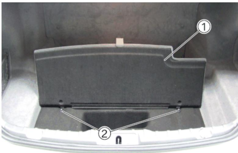
Heckklappe öffnen und Gepäckraum-Bodenverkleidung (1) hochklappen.
