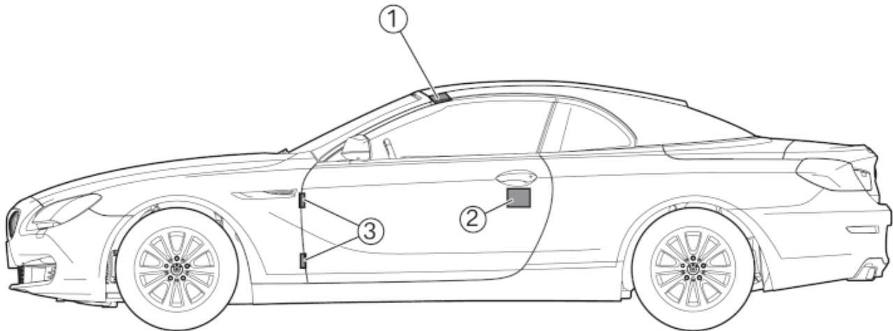
1. Die Flächen kennzeichnen die Bereiche, an denen das Dach abgetrennt werden kann. Voraussetzungen zum Aufschneiden der Karosserie sind moderne Hochleistungsscheren. Ältere hydraulische Schneidgeräte können überfordert sein.
