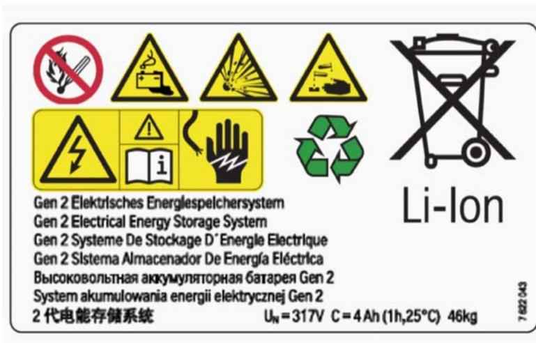
Kennzeichnung der restlichen Hochvolt-Bauteile:
