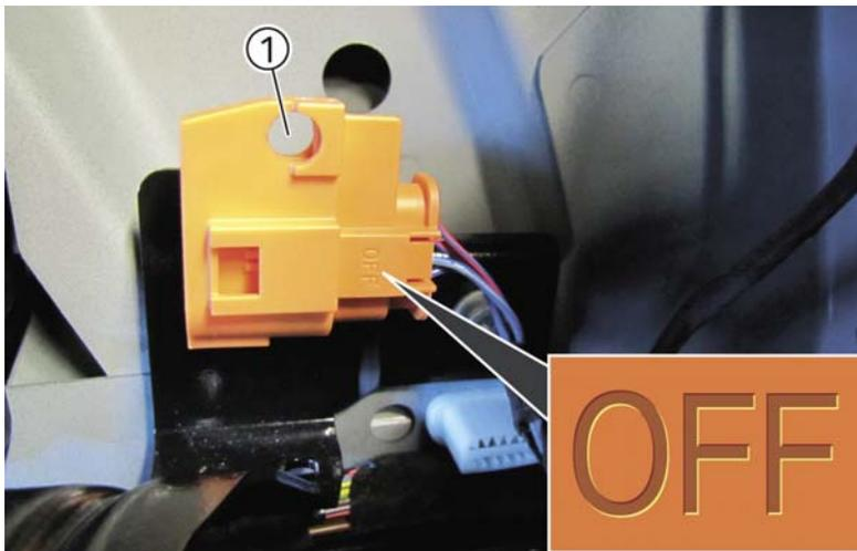
Mutter lockern und Batterieminusleitung (1) nach oben abziehen.
