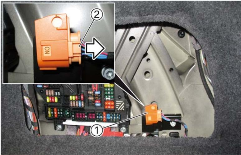
Das Hochvolt-System ist deaktiviert, wenn die Bohrung (1) durchgängig frei ist und die Beschriftung "OFF" am Stecker sichtbar ist.
