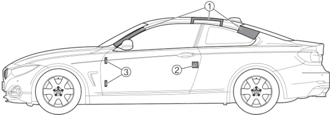
1. Die Flächen kennzeichnen die Bereiche, an denen das Dach abgetrennt werden kann. Voraussetzungen zum Aufschneiden der Karosserie sind moderne Hochleistungsscheren. Ältere hydraulische Schneidgeräte können überfordert sein.
