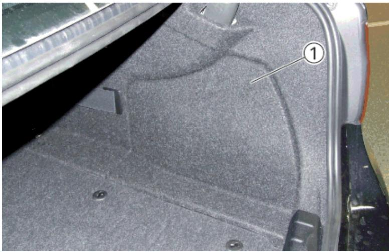
Heckklappe öffnen und Serviceklappe (1) von Gepäckraumverkleidung rechte Seite abnehmen.
