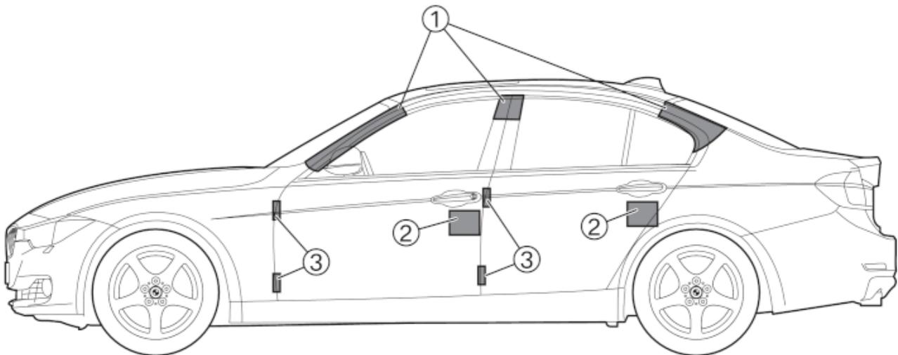
1. Die Flächen kennzeichnen die Bereiche, an denen das Dach abgetrennt werden kann.
