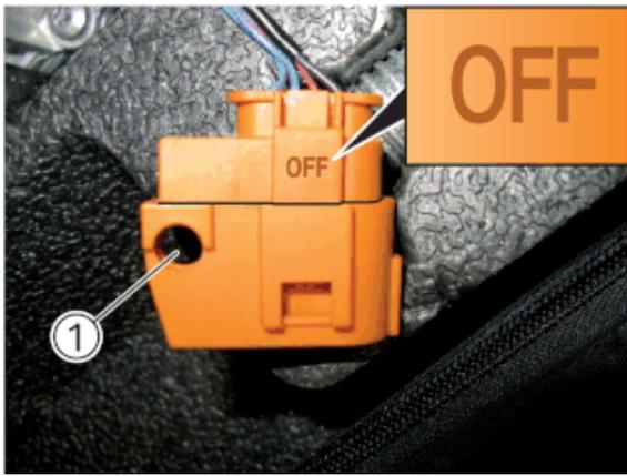
Das Hochvolt-System ist deaktiviert, wenn die Bohrung (1) durchgängig frei ist und die Beschriftung "OFF" am Stecker sichtbar ist.
