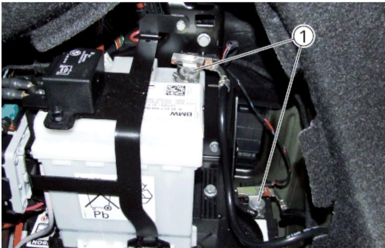
Muttern lockern und beide Batterienusleitungen (1) nach oben abziehen.
