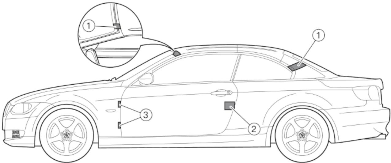
1. Die Flächen kennzeichnen die Bereiche, an denen das Dach abgetrennt werden kann:
