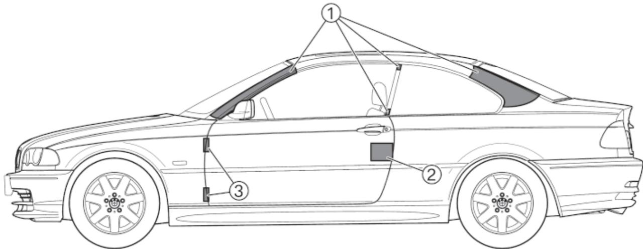
1. Die Flächen kennzeichnen die Bereiche, an denen das Dach abgetrennt werden kann. Voraussetzungen zum Aufschneiden der Karosserie sind moderne Hochleistungsscheren. Ältere hydraulische Schneidgeräte können überfordert sein.
