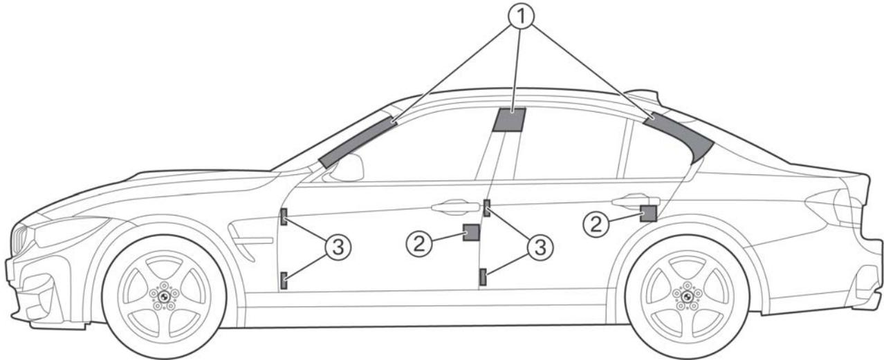
1. Die Flächen kennzeichnen die Bereiche, an denen das Dach abgetrennt werden kann. Voraussetzungen zum Aufschneiden der Karosserie sind moderne Hochleistungsscheren. Ältere hydraulische Schneidgeräte können überfordert sein.
