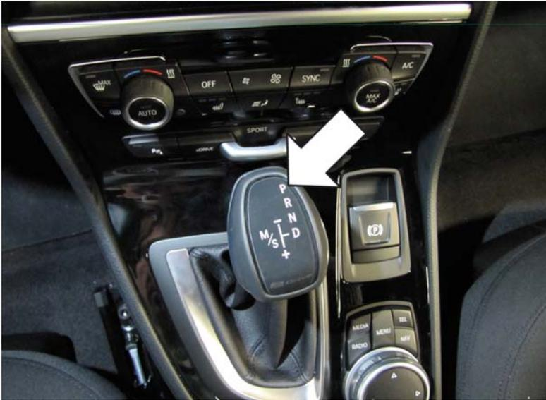
Schalter für elektrische Parkbremse nach oben ziehen.
