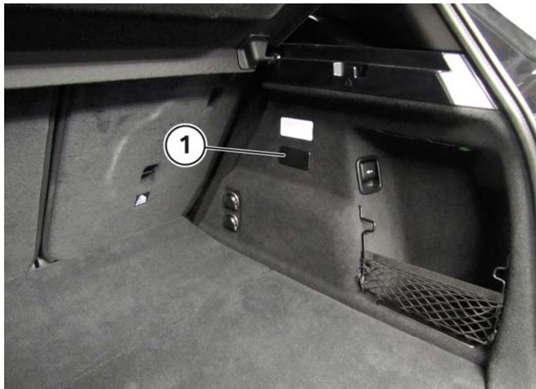
Stecker-Trennsicherung 1 nach unten drücken und herausziehen. Stecker für Hochvolt-Rettungstrennstelle 2 (Service Disconnect) in Pfeilrichtung auseinanderziehen.
