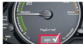
Die Betriebsbereitschaft kann ggf. nicht an den Betriebsgeräuschen erkannt werden, da die Elektromaschine geräuschlos ist. Solange die linke große Zeigeranzeige im Kombi (Powermeter) nicht auf „OFF“ steht (z. B. auf Position „READY“), ist mit einem E-Maschinenbetrieb oder auch mit einem automatisch startenden Verbrennungsmotor zu rechnen.
