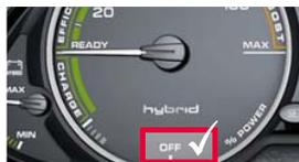
Die Betriebsbereitschaft kann ggf. nicht an den Betriebsgeräuschen erkannt werden, da die Elektromaschine geräuschlos ist. Solange die linke große Zeigeranzeige im Kombi (Powermeter) nicht auf „OFF“ steht (z. B. auf Position „READY“), ist mit einem E-Maschinenbetrieb oder auch mit einem automatisch startenden Verbrennungsmotor zu rechnen.
